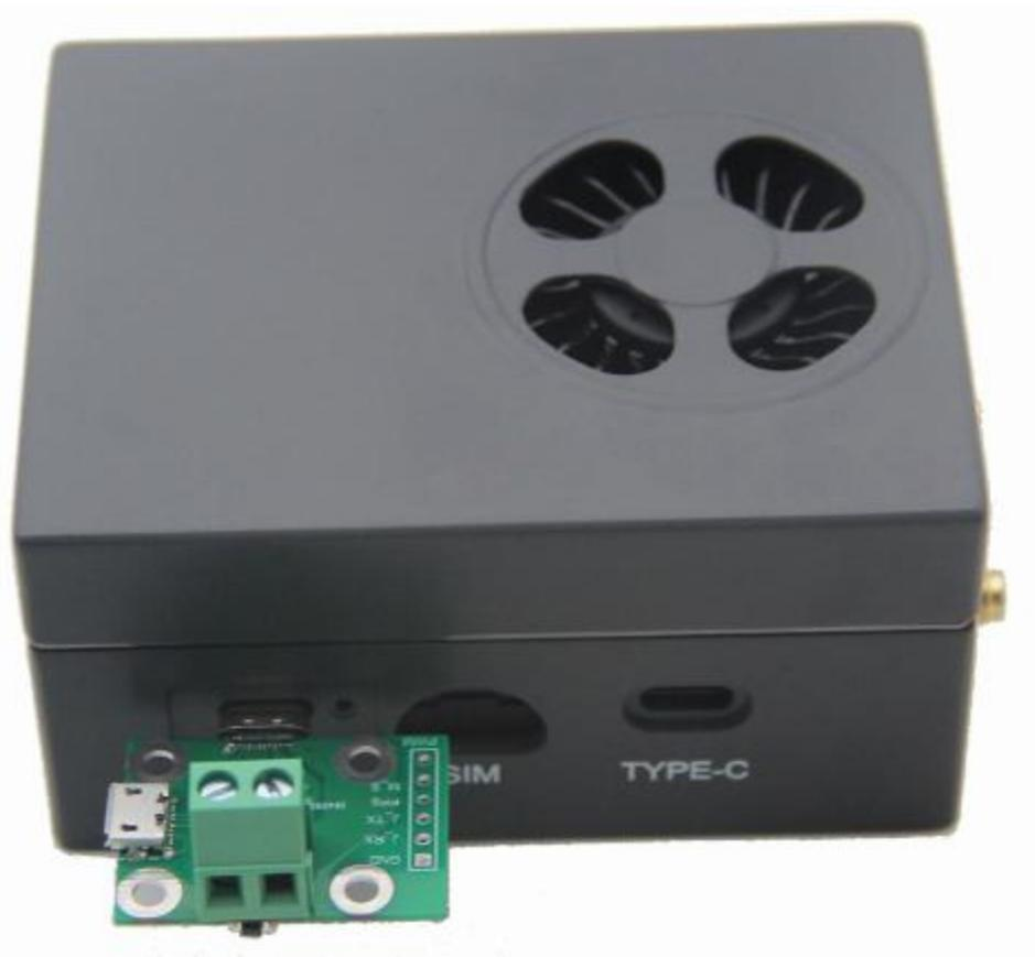
2. 将 micro-usb 数据线的 microUSB 插头插入 OSDK 信号分离板的 microUSB 母座连接器中，将 micro-usb 数据线的另一端 USB TYPEA 插头插入到烧录主机的 USB 母座连接器中
