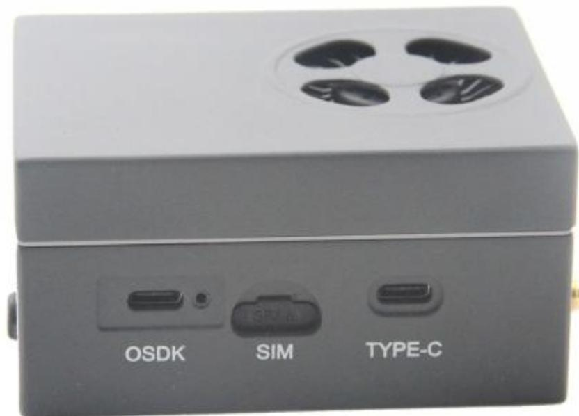
17F1 是一款适配大疆 M300、Mavic3 、M30、Matrice 350 系列飞机，基于 NVIDIA Jetson Xavier NX/Orin NX/Orin Nano 系列核心模组设计的机载 AI 计算平台。
