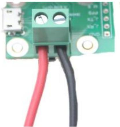
4. 按住如下图所示的 Rec 按键不松开，给 12V DC 电源通电，电源通电 3 秒后松开按键。此时 17F1 会进入 Recovery 模式。
