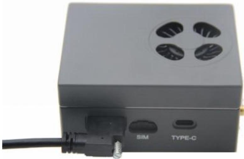
2. 使用大疆商城采购的单端未包胶 OSDK 同轴连接线连接 17F1 时，需要注意 OSDK 连接线接入方向如图所示（A 面朝上）：
